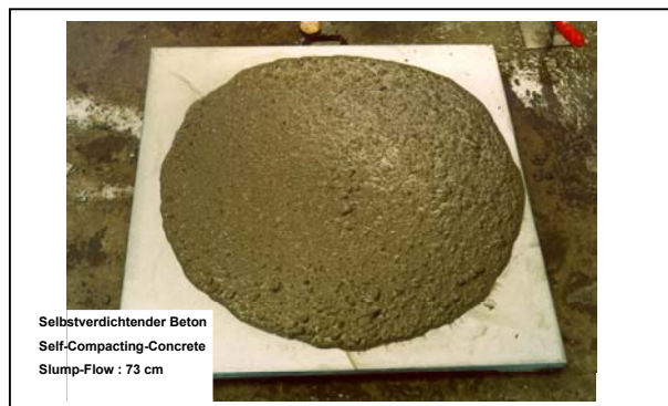
Figura 4. Slump-flow di un calcestruzzo SCC, (elevato spandimento, assenza, sui bordi, di boiaccia e di acqua di essudazione).
