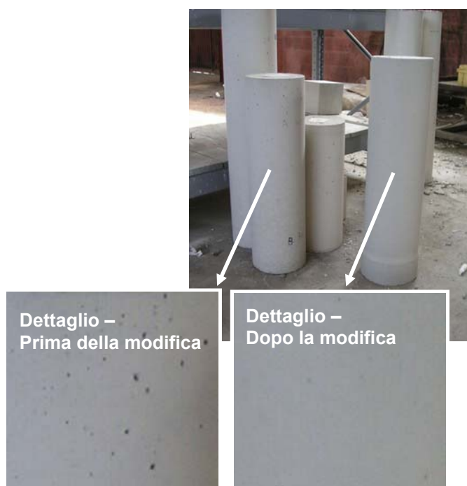
Fig. 3 - Confronto tra i cilindri prodotti in laboratorio centrale Unical con COMPACTCRETE 39/T75 e 39/T75 SCC : dettagli del faccia a vista.
