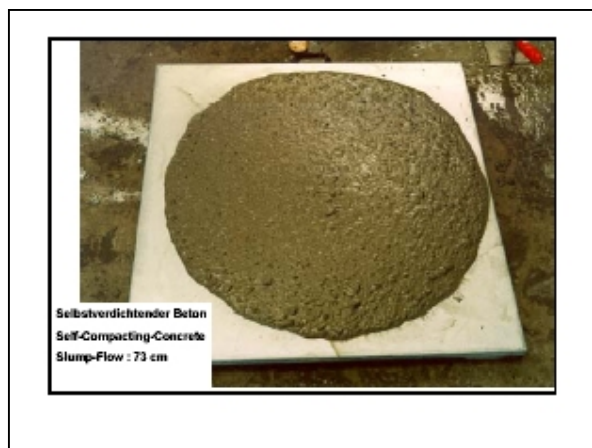
Figura 1. Slump-flow di un calcestruzzo SCC, (elevato spandimento, assenza, sui bordi, di boiaccia e di acqua di essudazione).
