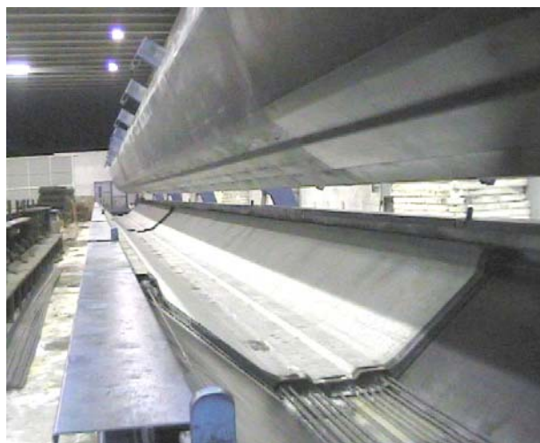
Figura 11: Fase di apertura del controcassero.
